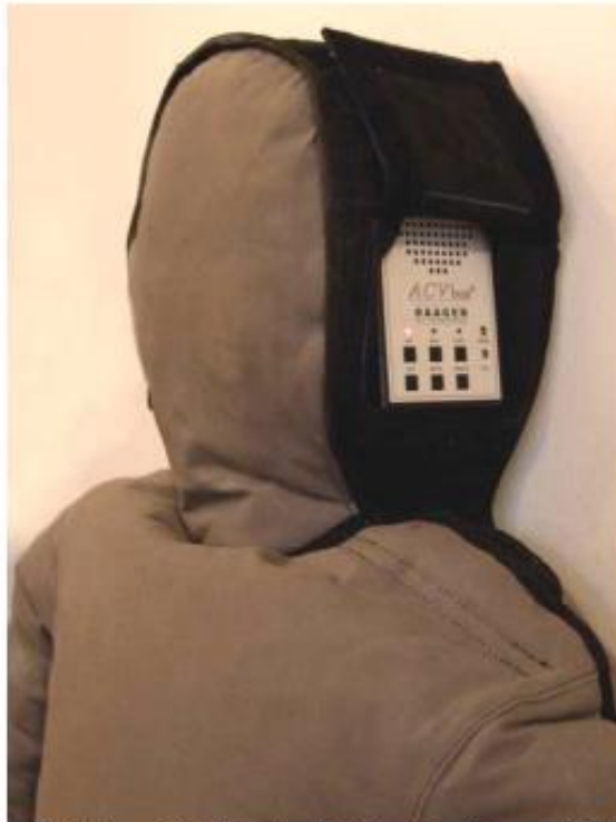
Abbildung 6: ACV Box im Kopf des SmartDummy™ Thermal
