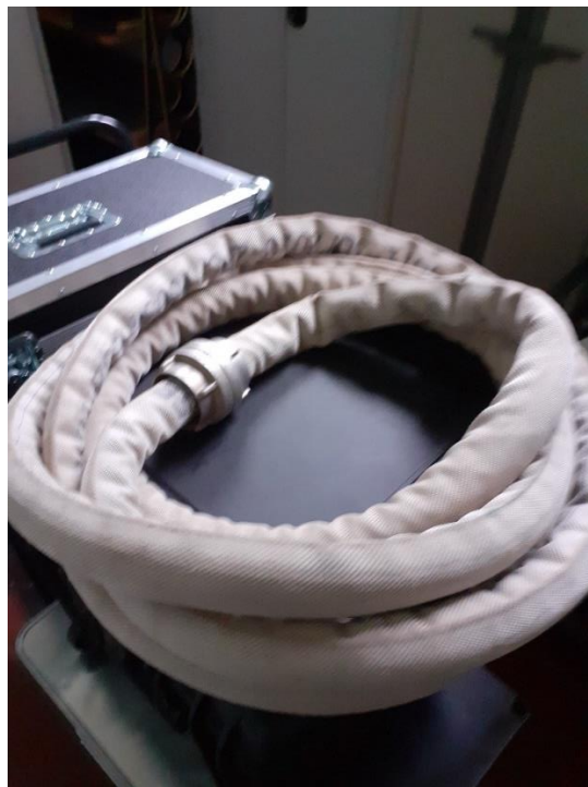
4 Stück „Beschwerter“ C-Schlauch ca. a 7,50 m lang zum Anschluss an das Digitale Hohlstrahlrohr
